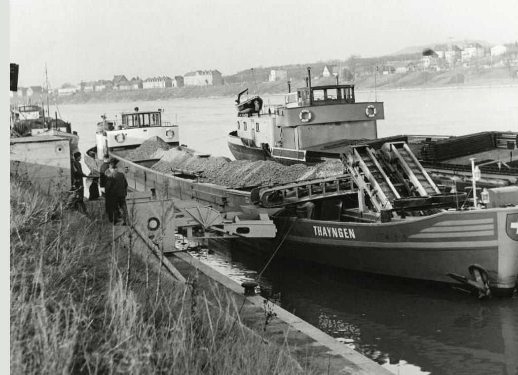
Das Motorkiessschiff «Thayngen» wird zum Prototyp des selbstentladenden Schiffes auf dem Rhein. Seine Ladekapazität beträgt 550 Tonnen.
